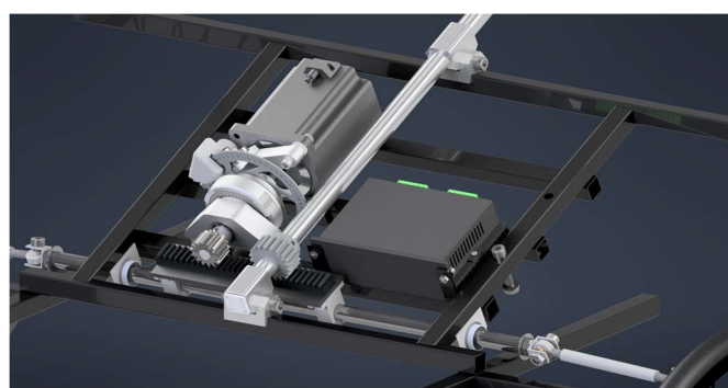
5. ábra léptetőmotor beépítése a kormányműbe
