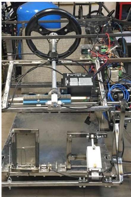
6. ábra fékpedál és a gázpedál a munkahengerrel
