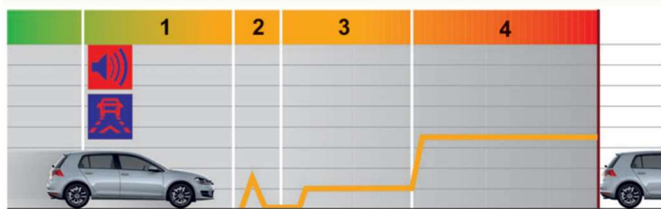
1. ábra Automatikus vészfékrendszer működésbe lépésének szakaszi a VW Golf széria esetében
