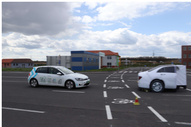
9. ábra Vészfékrendszer tesztelési folyamat a ZalaZONE-on
