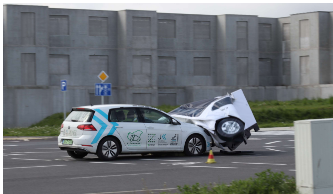
17. ábra Helytelenül kalibrált radarral végzett AEBS teszt
