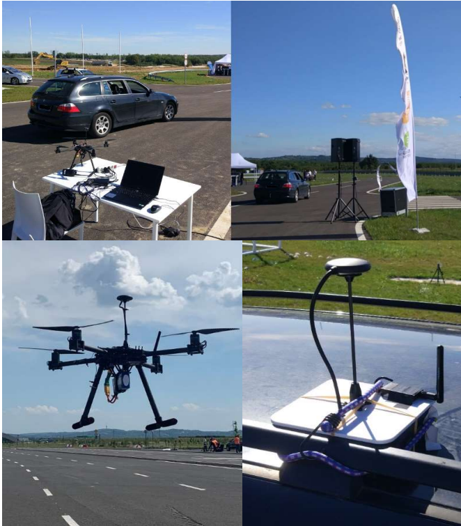
7. ábra: fent a teszt setup, lent az X500 drón, illetve az autóra erősített PX4-in a box kommunikációs eszköz látható (Szirocák és Rohács, 2021)
