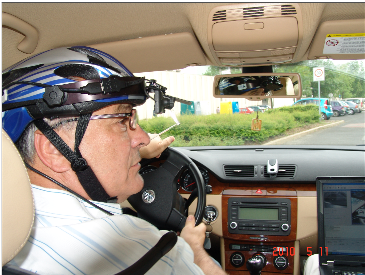
15. ábra: A gépkocsivezető fejére szerelt kamera egység
