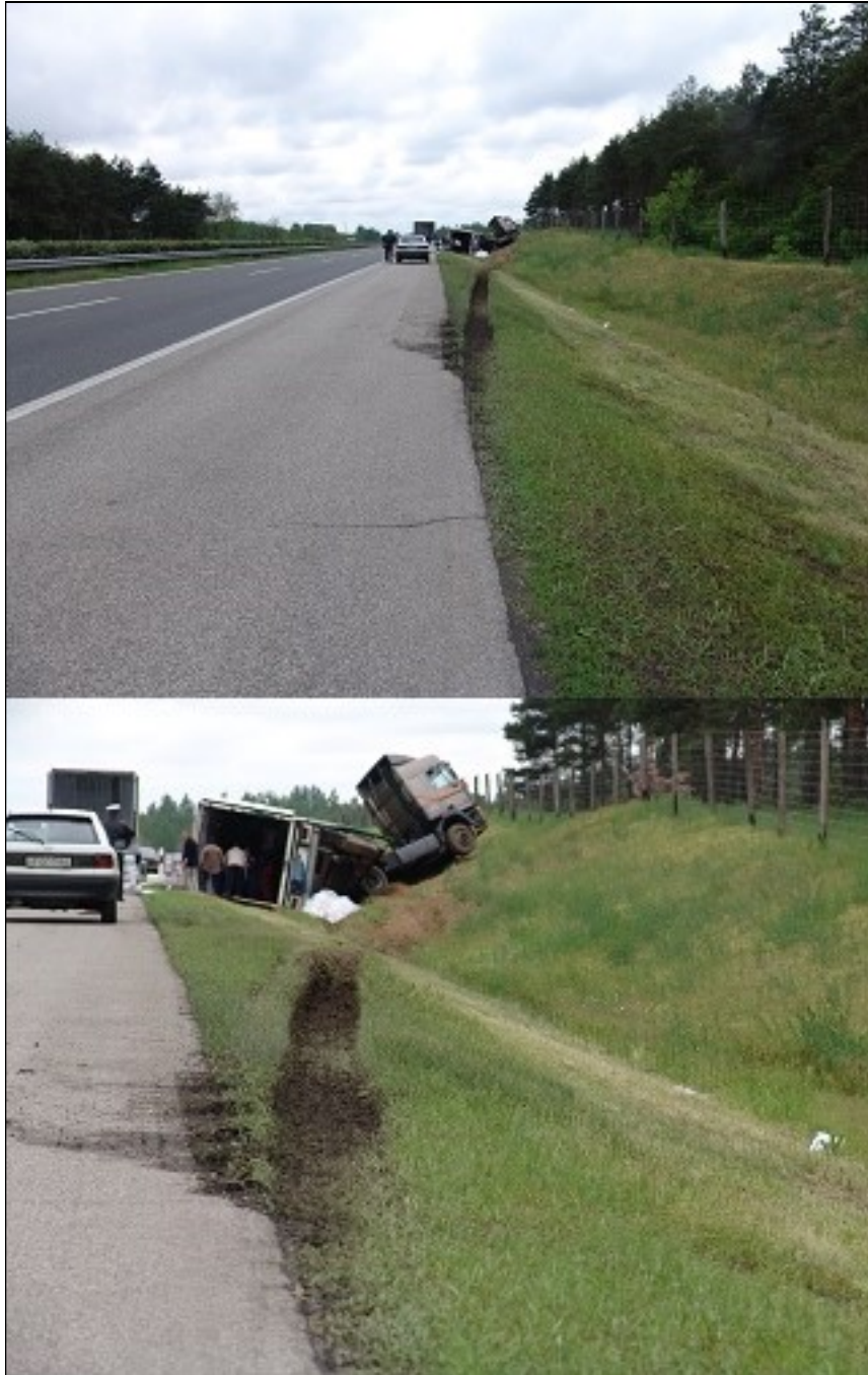
3. ábra: Tipikus elfáradásra- másodperc elalvásra utaló pályaelhagyási nyomok és következményeik
