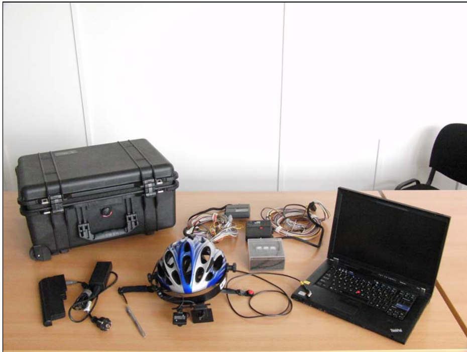
21. ábra: A szemmozgás vizsgálatára használt berendezés
