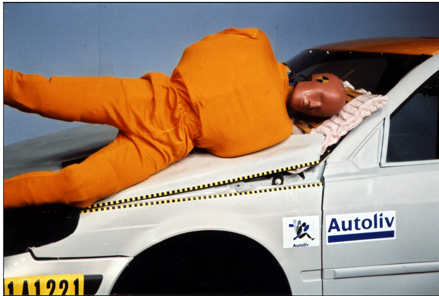
9. ábra: Az Autoliv védelmi rendszer működése
