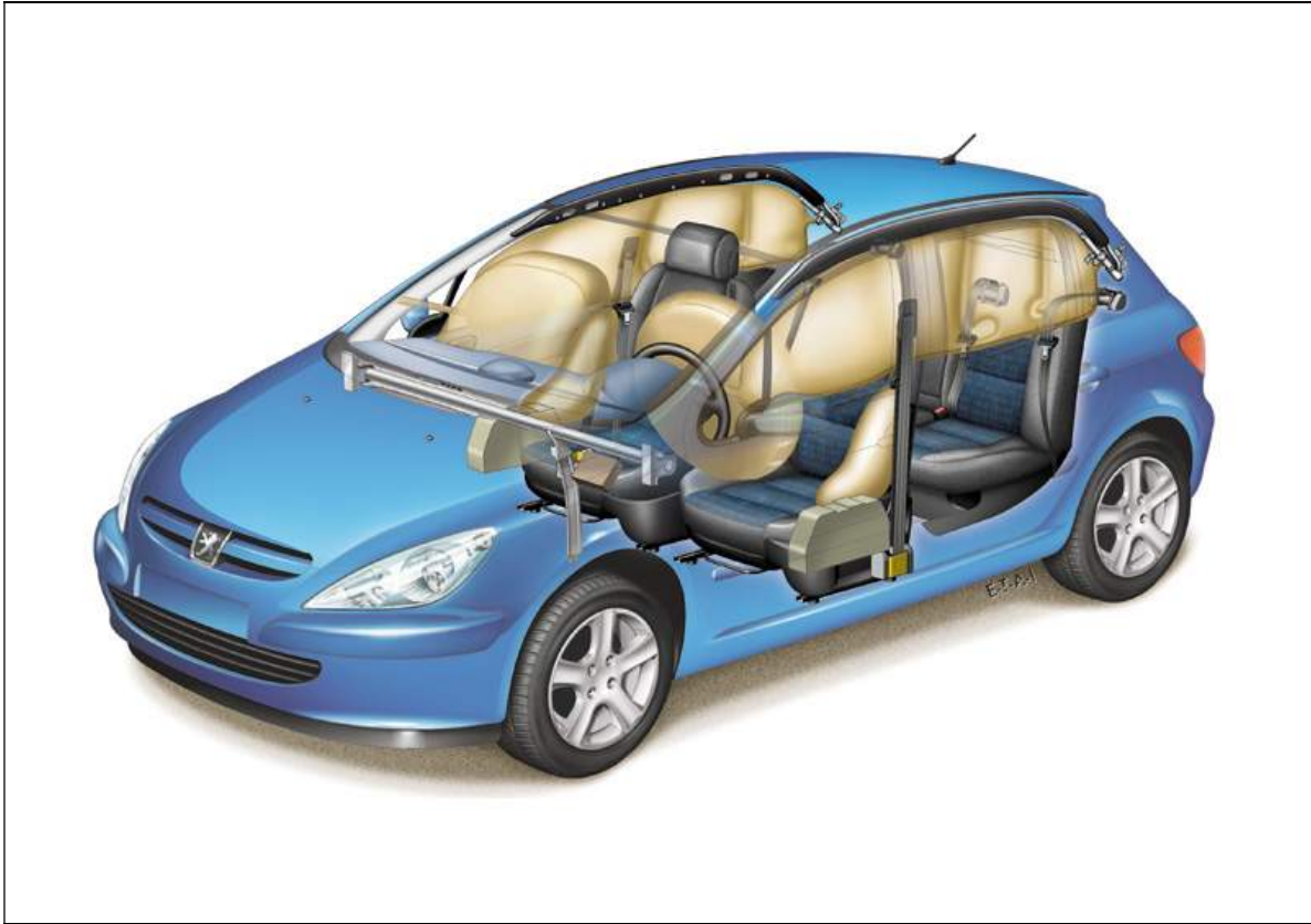
2. ábra: A Peugeot 307 típusú gépkocsik légszák kialakításai
