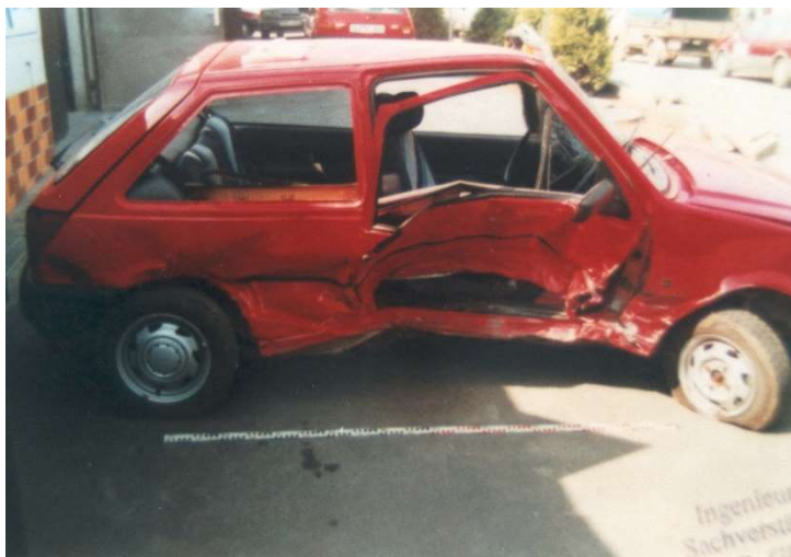
7. ábra. A baleseti helyszín és a jármű deformációk
