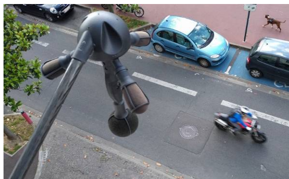
3. ábra: A kibocsátott zaj mérésére alkalmazott „Méduse”
