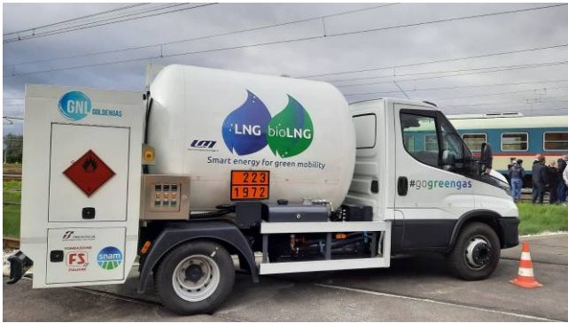
Fig. 9.: Példa egy kis kapacitású mobil LNG töltőegységre. (forrás: SNAM)
