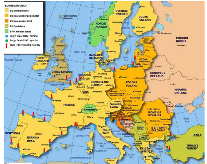
Fig.13.: Európai LNG importterminálok és közúti tréler töltésre kialakított terminálok 2021 tavaszi helyzetképe. [forrás: szerző gyűjtése]
