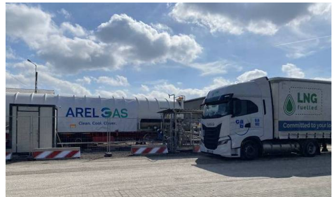
Fig. 8.: Mozgatható LNG töltőállomás tankolást végző LNG nyergesvontatóval. (forrás: szerző)
