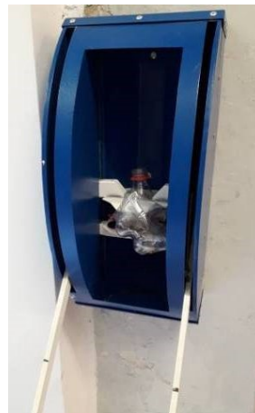
1. ábra: szerkezet PET palack térfogatsökkentésére
