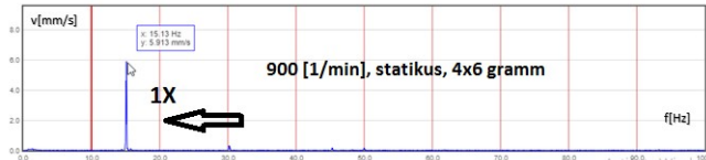
18. ábra Statikus kiegyensúlyozatlanság okozta rezgés spektruma 900 [1/min] fordulaton 4x6g póttömeg esetén
