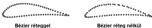
8. ábra: repülő-felületek Bézier-GAN felhasználásával és a Bézier réteg felhasználása nélkül ( Chen et al., 2019 ).
