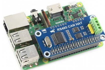
4. ábra: RS485 CAN HAT és Raspberry Pi
