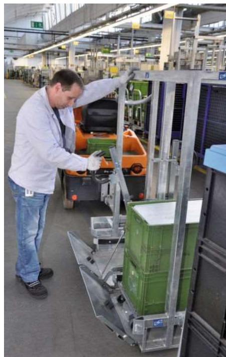
1. ábra. Vontatótargonca alkalmazása üzemi belső anyagmozgatási feladatokra (Rother, 2011)
