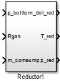
9. ábra A reduktor maszkolt modellje
