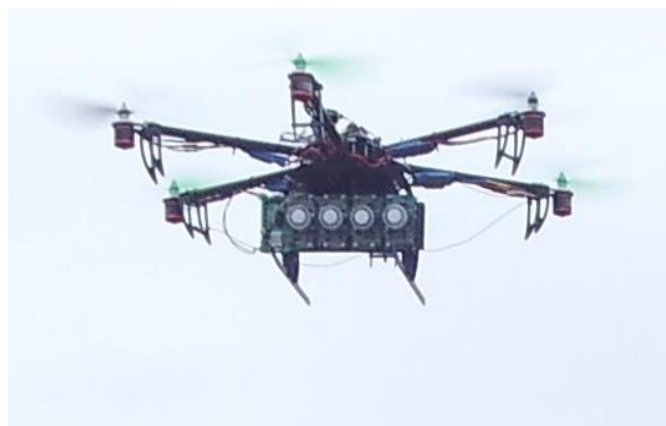
8. ábra, a drónra szerelt mérőmodul
