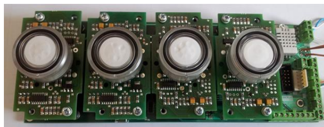
7. ábra, intelligens mérőmodul a gázszenzorok felől nézve
