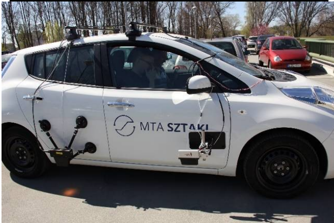
1. ábra: Mérőrendszer főbb elemei a kísérleti járművön
