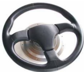
3. ábra: Corrsys-Datron MSW-2 kormányzási nyomatékmérő szenzor és a méréshez használt kormánykerék
