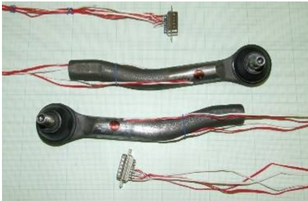
10. ábra: Egy rozetta elhelyezése és a rozetták bekötése
