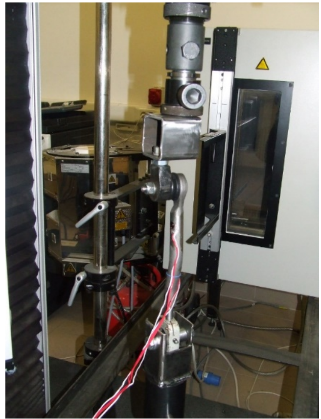
11. ábra1: A befogó készülék kialakítása és a mérés összeállítása
