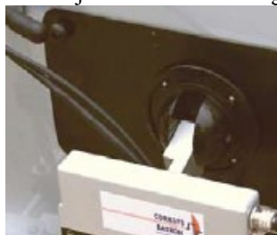
5. ábra: Corrsys-Datron HT500 felszerelése a járműre
