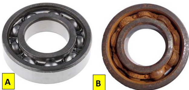
2. ábra A kísérletsorozathoz használt 6205 típusú mélyhornyú golyóscsapágy. (A) új hibátlan csapágy, (B) a korróziós károsodást szenvedett szöghajtómű csapágy
