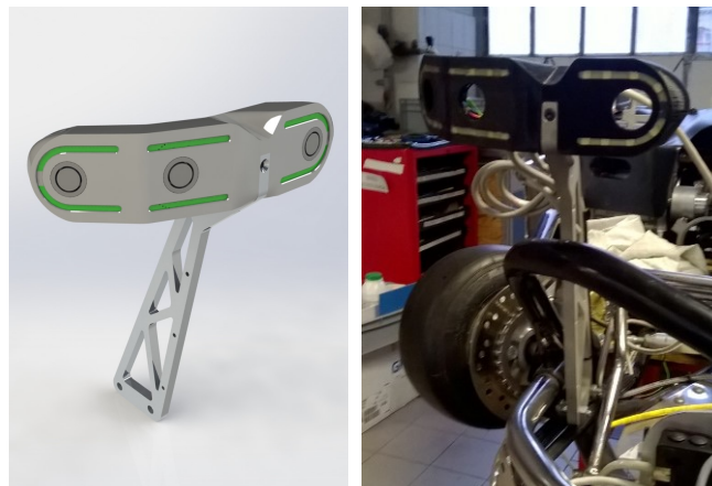
10. ábra. Ultrahang szenzor beépítése.
