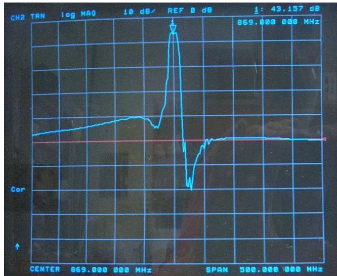
11. ábra LNA áramkör erősítése
