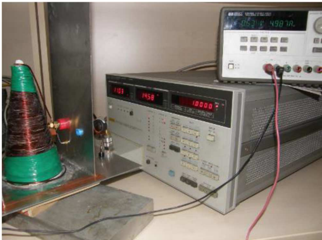
7. ábra A Bias-T tekercsének mérése
