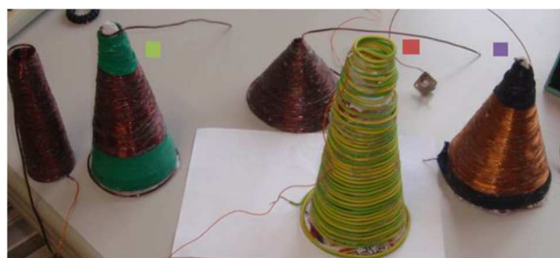
6. ábra Kúpos kivitelű kísérleti tekercsek a frekvenciatartomány kiterjesztésére
