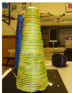
5. ábra Kúpos kivitelű kísérleti tekercsek
