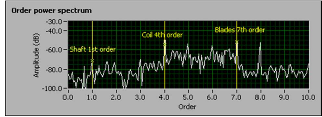
7. ábra. A ventilátor order spektruma a gyorsítási folyamat alatt felvéve (NI2005)
