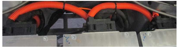
9. ábra Akkumulátorok bekötése
