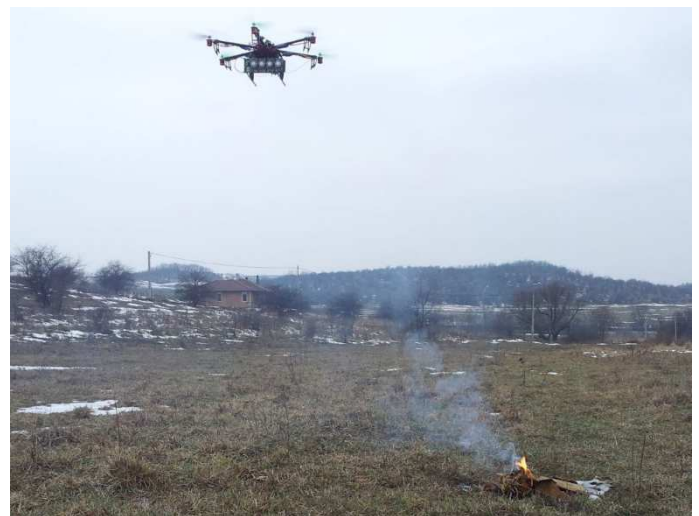
2. ábra, kísérleti repülő eszköz a mérőmodullal, légköri szennyezők 3 dimenziós feltérképezésére
