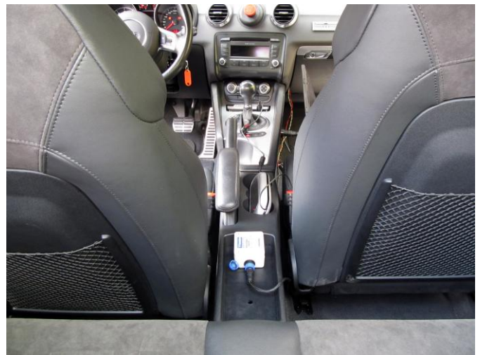
a, Hatszabadságfokú inerciális szenzor (VSDU) beépítése a gépjárműbe
