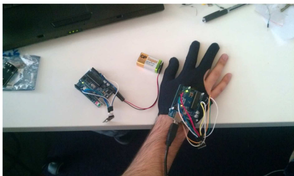
11. ábra: A külső vezérlő egység és a három-ujjas kesztyű
