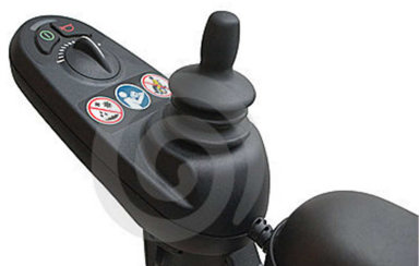
1. ábra: Joystick, elektromos mozgáskorlátozott járművön.
