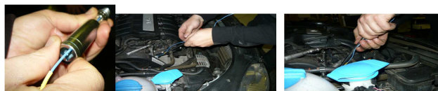
10. ábra: indikáló gyújtógyertya beszerelése a motorba
