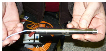
11. ábra: indikáló gyertya összekötése a gyertya adapterrel (erősítő)
