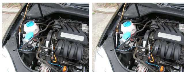
15. ábra: az indikáló gyújtógyertya bekötése
