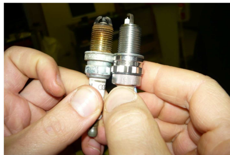
9. ábra: az indikáló gyújtógyertya méreteinek ellenőrzése
