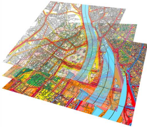
7. ábra: A 3D-s zajtérkép ábrázolása többrétegű módszerrel Budapest példáján
