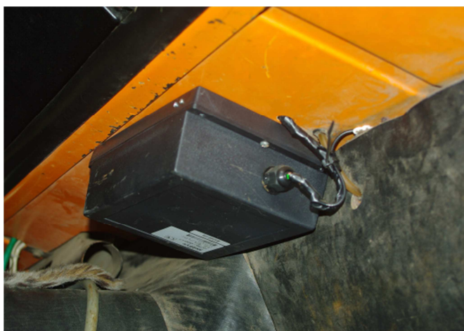
8. ábra: Járműfedélzeti eszköz elhelyezése a műszerfal alatt
