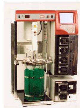
1. ábra Biogáz fermentor blokk
