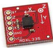
4. ábra: Háromdimenziós gyorsulás érzékelő.
