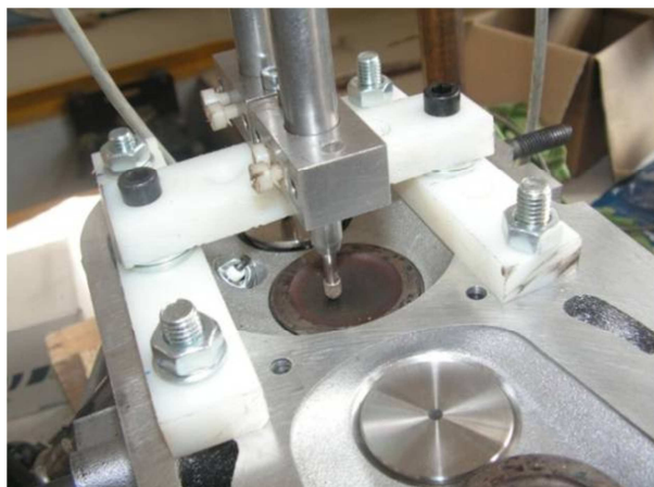
3. ábra: Szelepmelési görbe mérése löketadó
