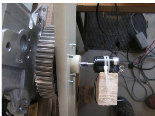
4. ábra: Szelepmelési görbe mérése (szögjeladó)
