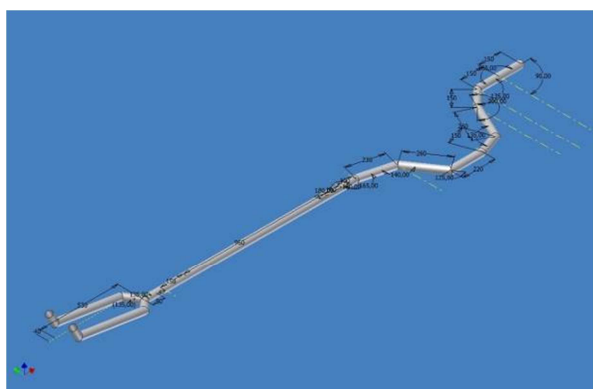
13. ábra: Kipufogórendszer geometriai méretek
