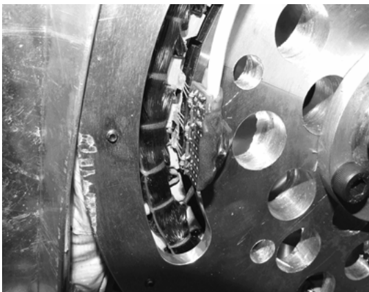
6. ábra A motor állórésze a Hall szenzorokkal
