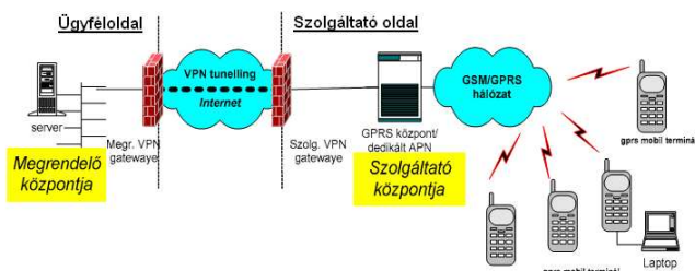
3. ábra: Biztonságos hálózati kapcsolat kialakítása (forrás: T-Mobile)
