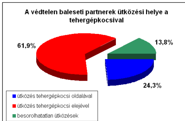
2. ábra: A védtelen baleseti partnerek felütközési helye a tehergépkocsin
