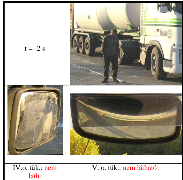
19. ábra: A résztvevők elhelyezkedése és a láthatósági viszonyok az elütés előtt t=2,0 s-mal (A gyalogos nem észlelhető)
