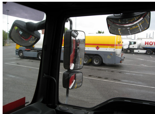
1. ábra: holtér visszapillantó tükrök alkalmazása; forrás: SHELL közlekedésbiztonsági konferencia
