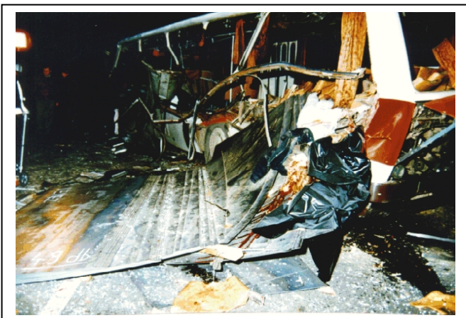
7. ábra: Hibás rakomány elhelyezés miatti tehergépkocsi- autóbussz ütközés (IbB)
