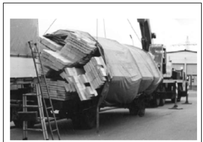
4. ábra A rakfelületen elcsúszott deszka rakomány ( Podzuweit)
