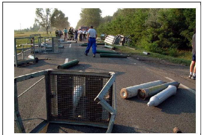
3. ábra: A hibás gázipalack rögzítés miatti rakományleesés következményei ( IbB)
