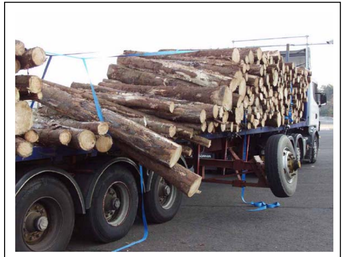
2. ábra: Ívmenetben elcsúszott rönkfa rakomány
