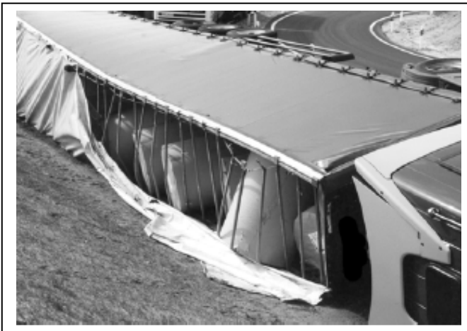
6. ábra: A teljes járműszerelvény borulása ívmenetben (www.ladungssicherung.com)
