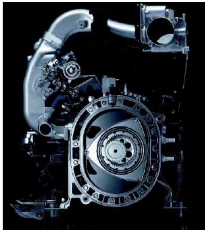
7. ábra: Mazda kettős üzemű Wankel (forgódugattyús) motorja közvetlen hidrogén befecskendezéssel
