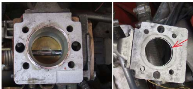
5. ábra: LPG-benzin kettős üzemű motor gázkeverő egysége.
